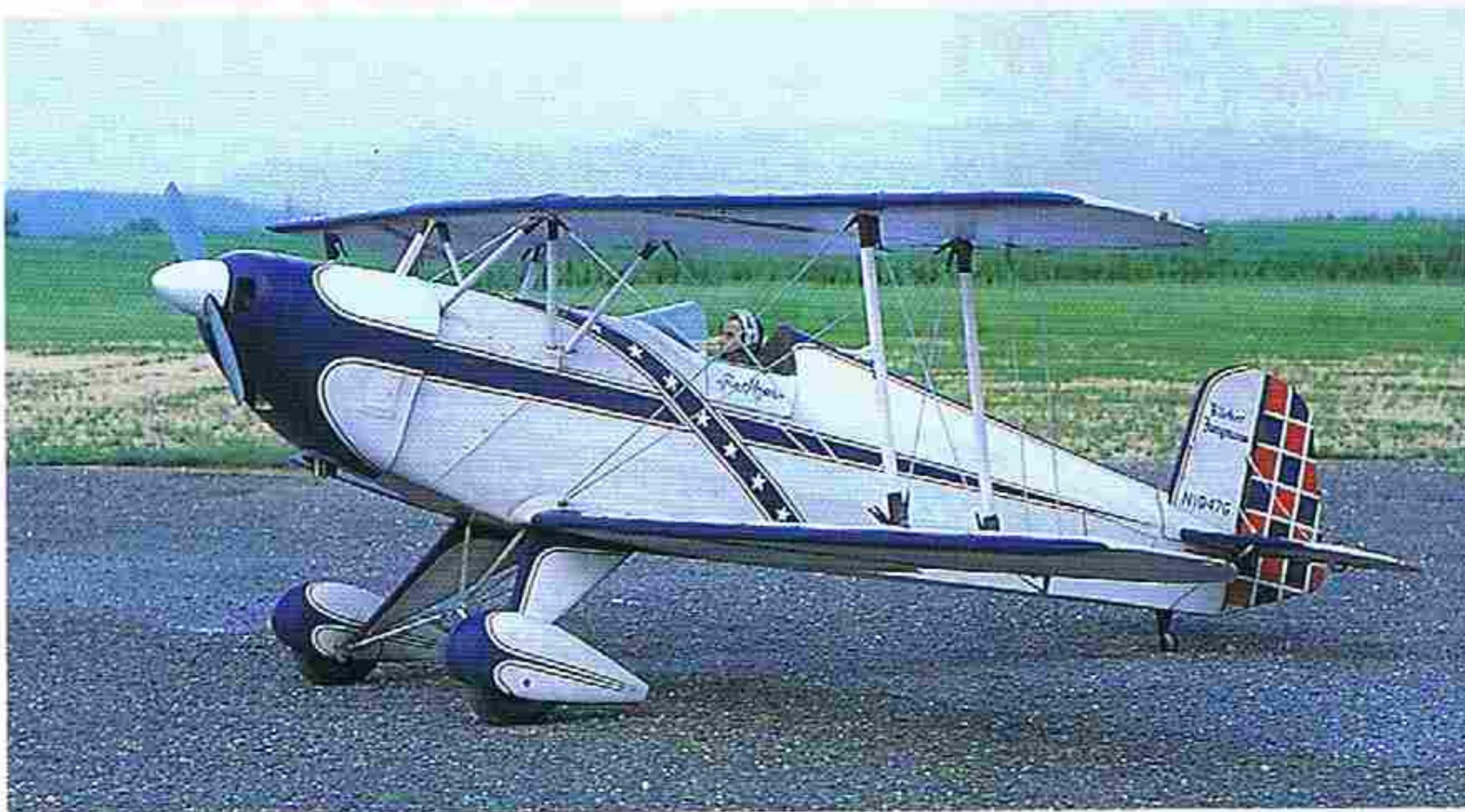
前回は、1/3.3スケールのビュッカー133ユングマイスターで出場(5位)した藤田義則選手(広島)，今回は、以前購入してあったOK模型製キットをベースに、また、アメリカに現存する実機資料をスケール・モデル・リサーチ・ジャパンから入手し、補強加工など、胴体と尾翼関係を主に大改造を施したビュッカー・ユングマンでの出場。プロペラは自作のグラス製D20×P10を装備。被覆はソーラーテックス張りのウレタン塗装仕上げとなっている。
