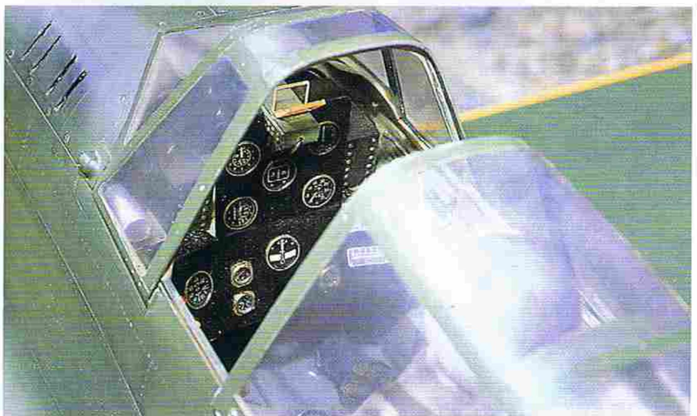
↑開閉可能なキャノピーを開けて、コクピット内部の計器盤などを見る。前回に比べ、コクピット内の艤装とキャノピー周りもグレードアップされている。
