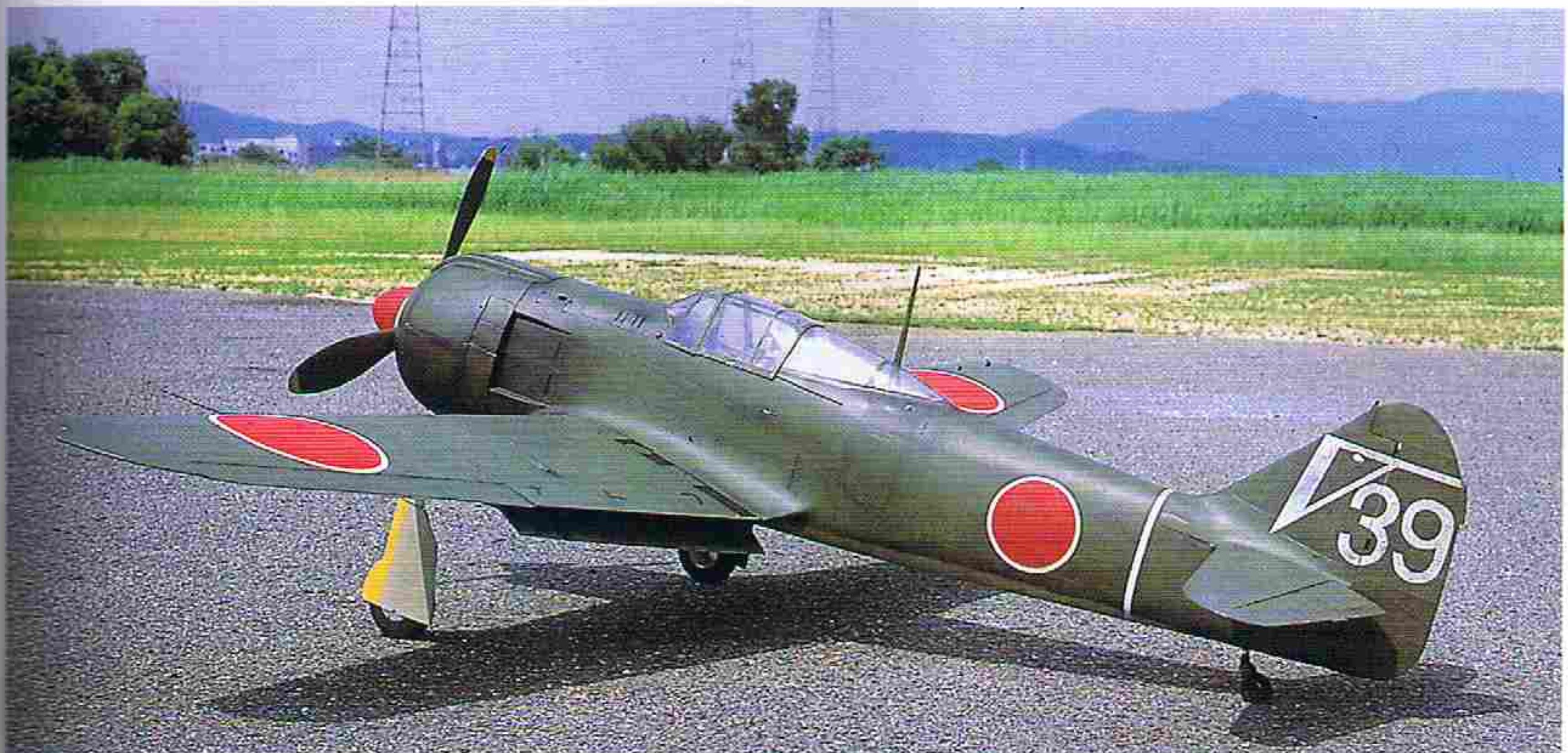
前回、本機（96年度F 4 C世界選手権出場機）で初優勝した安藤由隆選手（神奈川）は、さらにアンテナ碍子、搭乗時の引出しバー、酸素供給圧力調整機、電装パネルなどを追加装備して機体内外をスケール・アップ、エンジンもOS FS-120S EからOS FS-120S IIIに換装した同機で出場した。静止審査得点、飛行審査得点（2ラウンド目）も大会の最高点を獲得し、2連覇を果した。
